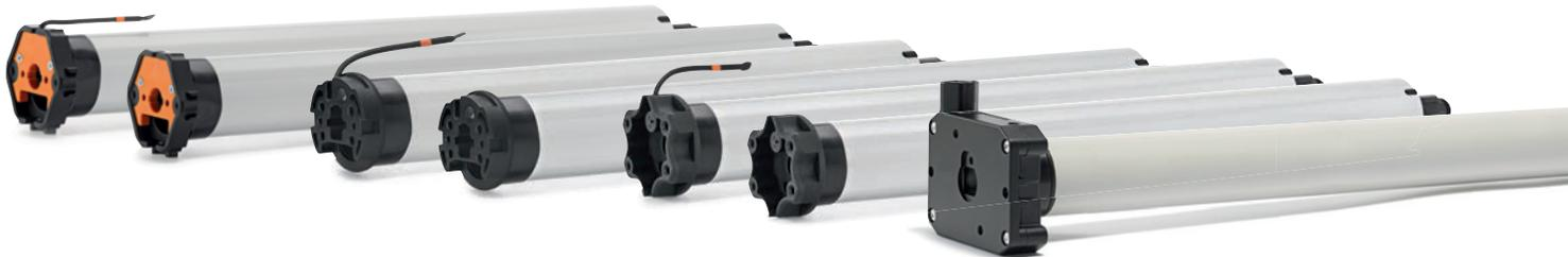
Die Rohrantriebe der RolTop M-Baureihe eignen sich mit einem Durchmesser von 45 mm und einer Länge ab 403 mm (K-Version) für platzsparende Rollläden, Rollos und Screens. Die meisten Antriebe gibt es sowohl mit wie auch ohne integriertem Funksystem. Es stehen Antriebe von 2,5 bis 50 Nm und je nach Ausführung mit 14 bis 90 Upm zur Verfügung. Für eine geräuscharme Bewegung des Behangs bieten sich Antriebe mit Softbremse (bis max. 20 Nm) an. Sämtliche Antriebe lassen sich
