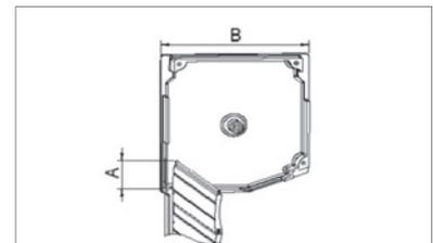
Der oberste Profilstab des Rollladens sollte nicht mehr als 1/2 der Profilhöhe aus der Führungsschiene herauskommen (A). Der „Hochschiebeeffect“ funktioniert nur, wenn die einzelnen Glieder sich gegeneinander abstützen und das erste Rollladenprofil nach unten in die Führung gedrückt wird!
