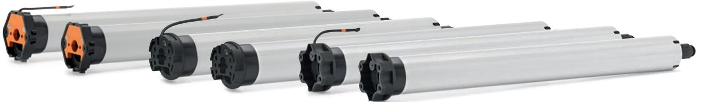
Die Rohrantriebe SunTop M-868 und SunTop M der M-Baureihe eignen sich speziell für die Anwendung bei Markisen, Rollos und Screens. Der mittelgroße Antrieb der SunTop-Baureihe ist mit einem Durchmesser von 45 mm und einer Länge ab 478 mm besonders für platzsparende Systeme ausgelegt. Die Antriebe gibt es sowohl mit wie auch ohne integriertem Funksystem. Es stehen 2,5 bis 50 Nm und je nach Ausführung 14 bis 90 Upm zur Verfügung. Wo Geräusche besonders
