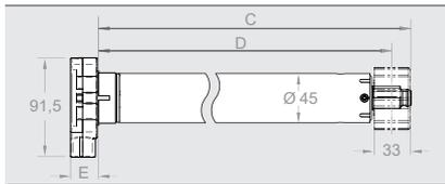
Nur in Verbindung mit starren Wellenverbindern einsetzbar!
