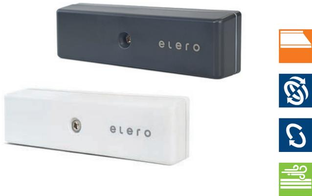
Batteriebetriebener, drahtloser Schwingungs- und Neigungs-sensor für Gelenkarmmarkisen, Windempfindlichkeit einstellbar, Wassersackerkennung.
