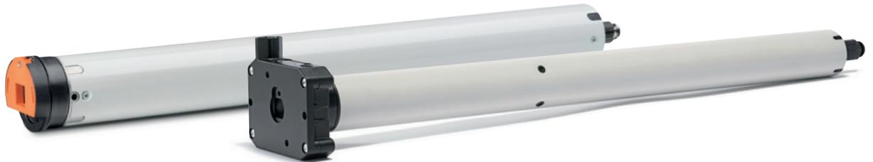
Die leistungsstarken Rohrantriebe der VariEco L-Baureihe sind mit einem Durchmesser von 58 mm für große Rollläden und den textilen Sonnenschutz ausgelegt. Es stehen Antriebe von 15 bis 120 Nm und je nach Ausführung mit 11 bis 64 Upm zur Verfügung.
